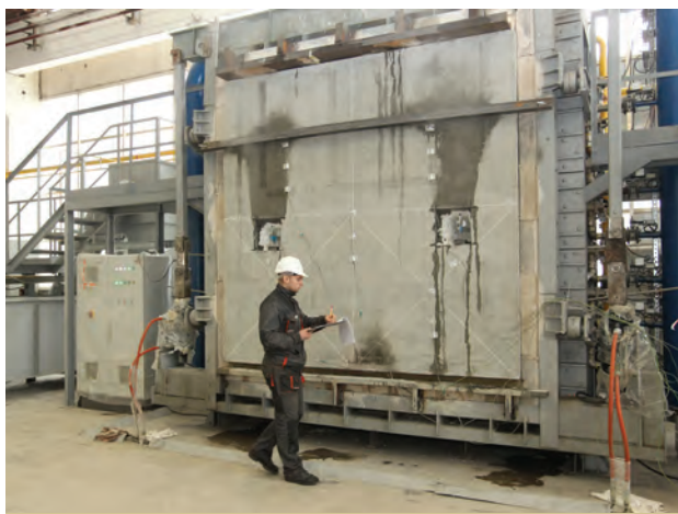
Проведение испытаний на огнестойкость наружных стеновых панелей
