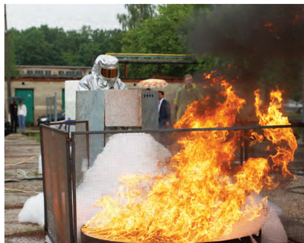
Стенд для испытания огнетушащих веществ
