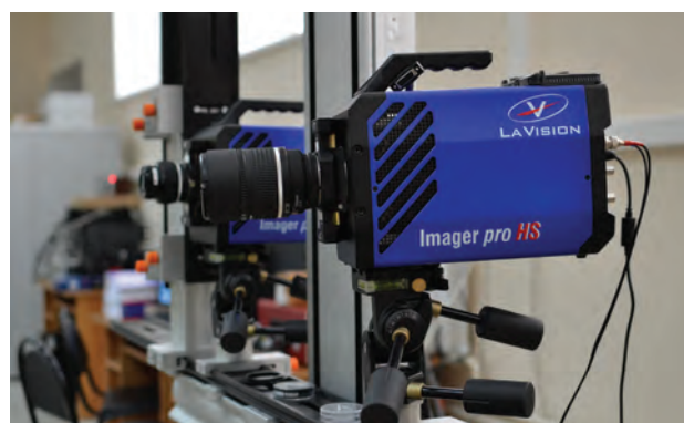
Высокоскоростная видеокамера для фотофиксации частиц в потоке и визуализации картограмм скоростных полей
