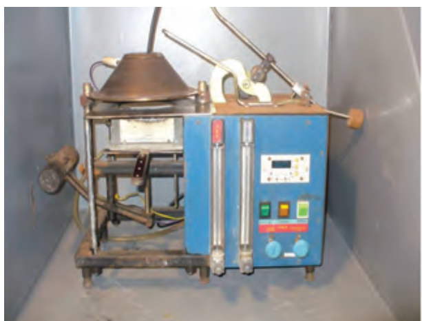
Установка для определения воспламеняемости строительных материалов «ВСМ»
