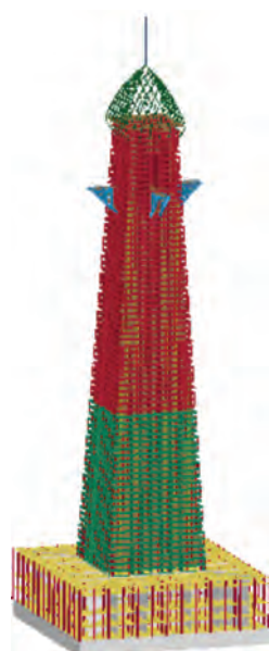
«Башня Ахмат» высотой 400 метров, проектируемая на площадке с интенсивностью землетрясения 9 баллов по шкале MSK-64.
