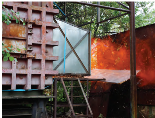
Стенд для испытания взрывобезопасности легкобросаемых фасадных конструкций
