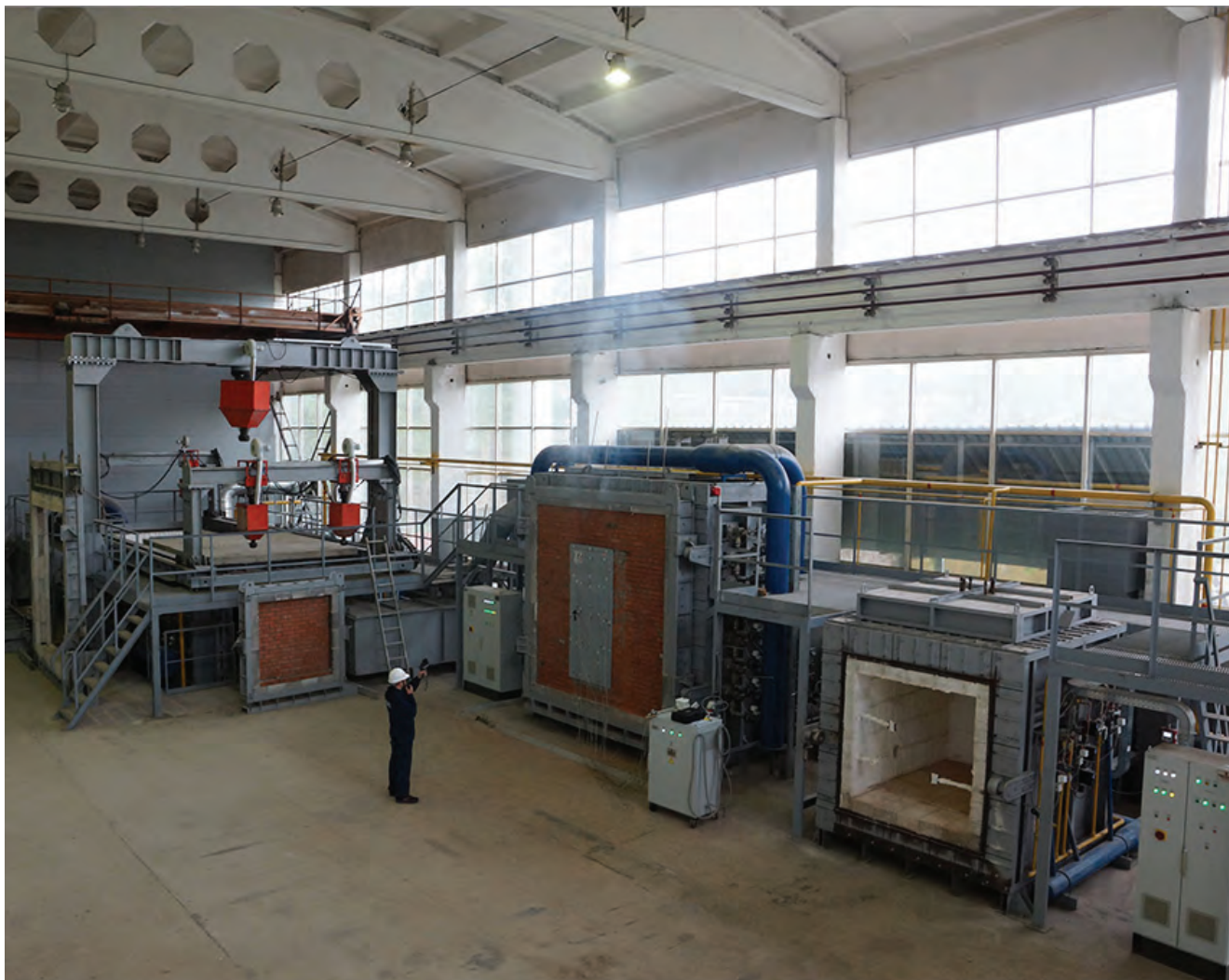
Испытательный комплекс для определения огнестойкости строительных конструкций
