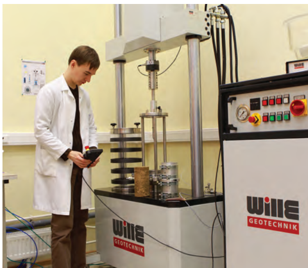
Универсальная установка для проведения динамических испытаний на сжатие
