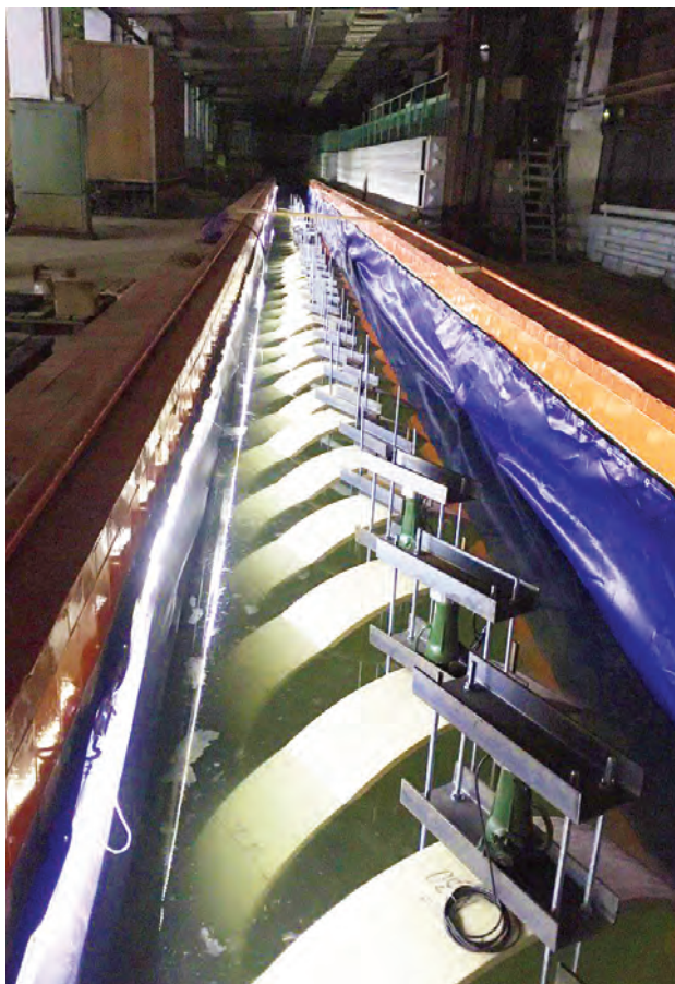
Проведение долгосрочных испытаний образцов стеклокомпозитных труб в соответствии с ГОСТ Р ИСО 10467-2013
