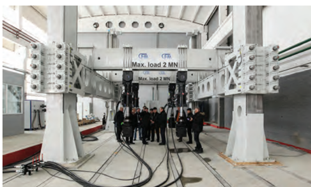
Универсальный реконфигурируемый стенд для испытаний крупногабаритных конструкций на статические и динамические нагрузки (5000 кН)
