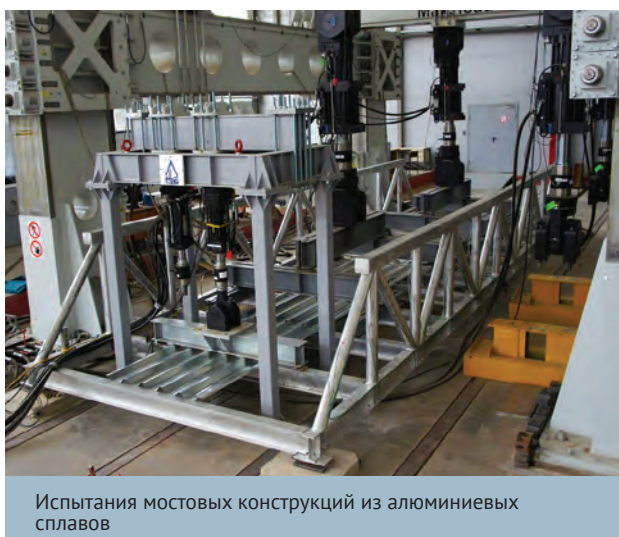
Универсальный реконфигурируемый стенд для испытаний крупногабаритных конструкций на статические и динамические нагрузки (5000 кН)
