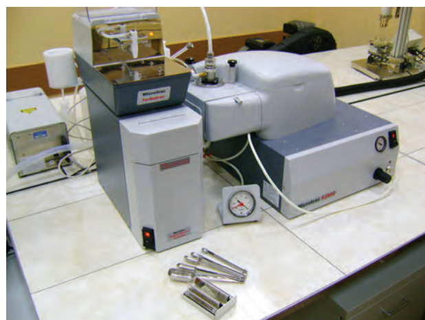
Лазерный анализатор размеров частиц Microtrac S3500
