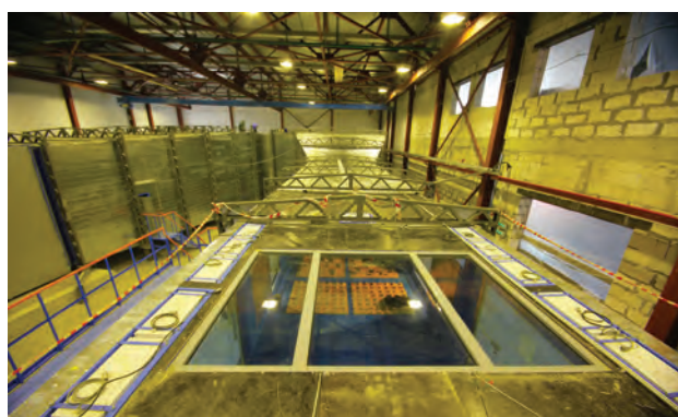
Остекление рабочей зоны АДТ НИУ МГСУ для работы лазерного оборудования и PIV-системы
