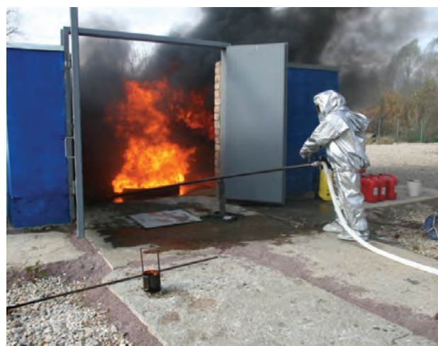
Стенд для испытания огнетушащих веществ
