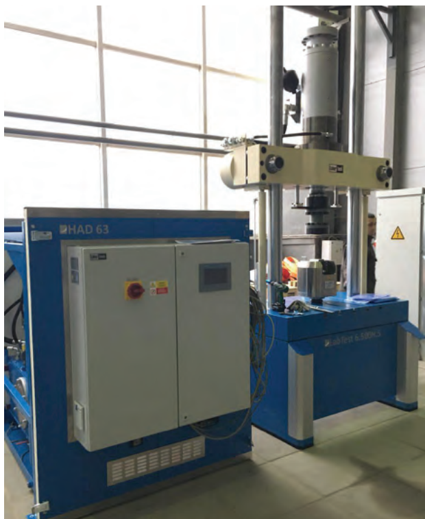
Универсальная динамическая испытательная машина LabTest 6.500H.5.01.1
