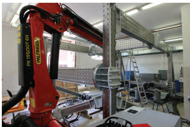
Реконфигурируемый стенд для испытаний строительных конструкций (1500 кН)
