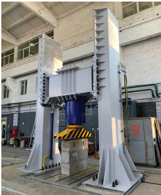
Стенд для испытаний крупногабаритных конструкций с нагрузкой до 15 000 кН
