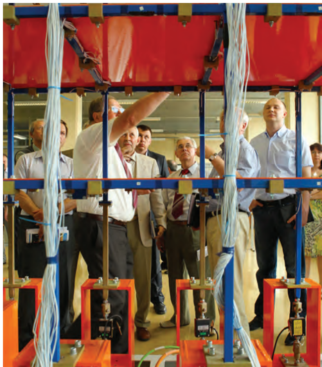
Стенд «Модель несущих конструкций многоэтажного каркасного здания»
