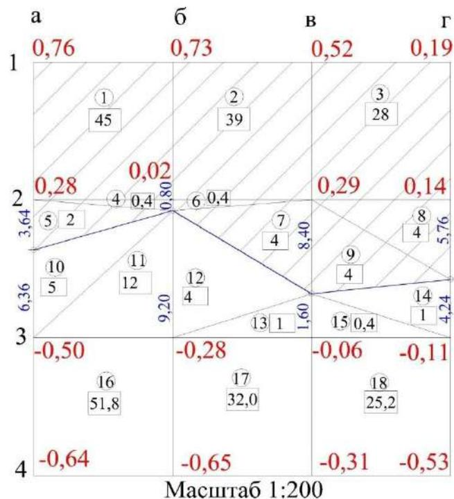
$$H_{\text{п}} = 46,05\text{м} \quad V_{\text{н}} = 127,1\text{м}^3 \quad V_{\text{в}} = 133,2\text{м}^3$$
